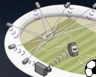
**Hawk Eye:** Drin oder nicht drin? Die Schiedsrichter dürfen an der EURO wiederum auf die Hilfe der Hawk Eye-Torlinientechnik setzen. Ist der Ball hinter der Linie, wird das dem Spielleiter mit einem Signalton auf der Uhr angezeigt. Verbunden sind die Unparteiischen über ein funkbasiertes Kommunikationssystem.
